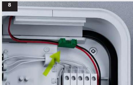
**SI** Priključite 2-polni zeleni SAURO konektor, ki povezuje LED osvetlitev z napajalnikom.
