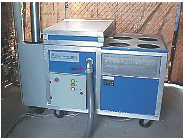
Slika 17. 7kW PEM gorivna celica za hišno uporabo firme Plug Power. Plug Power testira enoto od leta 1998. V letošnjem letu nameravajo gorivno celico ponuditi tržišču.
